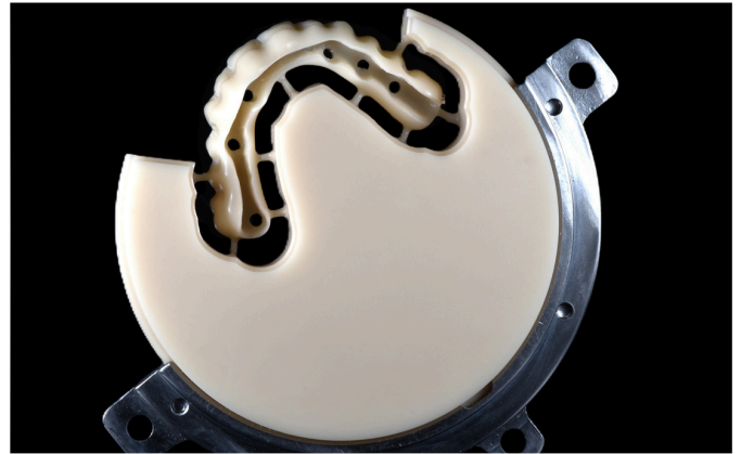
Fig. 14: Vista basal del resultado del fresado de la supraestructura.
