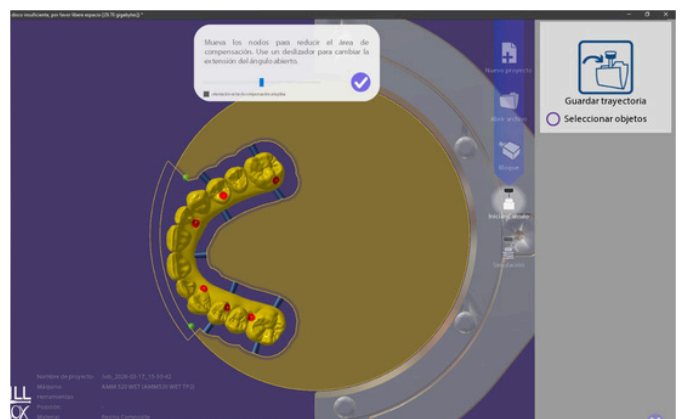
Fig. 12: El anidamiento de la supraestructura en el software CAM MillBox.
