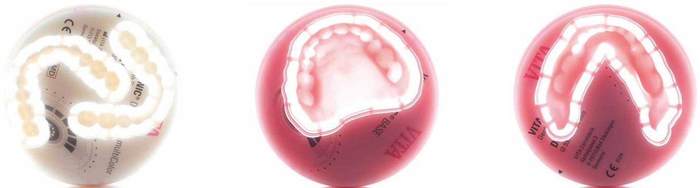
Abb. 3 bis 5: Aus den Fräsrohlingen VITA VIONIC DENT DISC multiColor und VITA VIONIC BASE DISC HI wurden die totalprothetischen Komponenten subtraktiv gefertigt.
