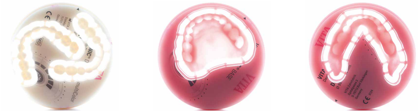
Figs. 3 a 5: A partir de las piezas en bruto fresables VITA VIONIC DENT DISC multiColor y VITA VIONIC BASE DISC HI se confeccionaron de forma sustractiva los componentes de la prótesis completa.
